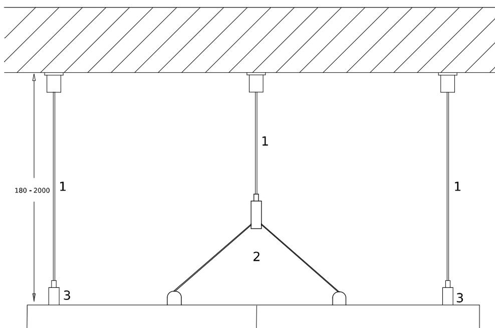
[2] - Terminal duplo para cabo de aço (2xM5/6 C/Base)
