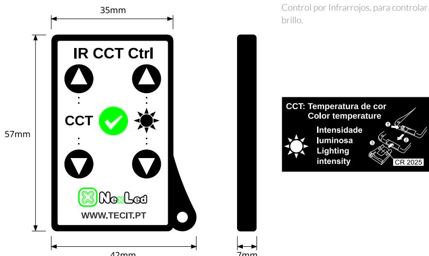
Control por Infrarrojos, para controlar las Barras LED CCT de 24V con ajuste de temperatura de color y brillo.
