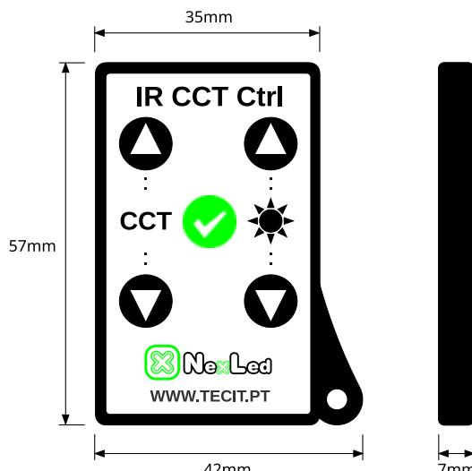
Contrôle infrarouge, pour contrôler les Barres LED 24V CCT avec réglage de la température de couleur et de la luminosité.
