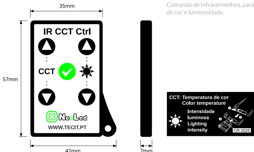
Comando de Infravermelhos, para controlo das Barras LED CCT 24V com ajuste da temperatura de cor e luminosidade.
