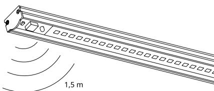
O controlo deverá de ser feito a uma distância máxima de 1,5 m entre o comando IR e o controlador CCT colocado no interior da barra.
